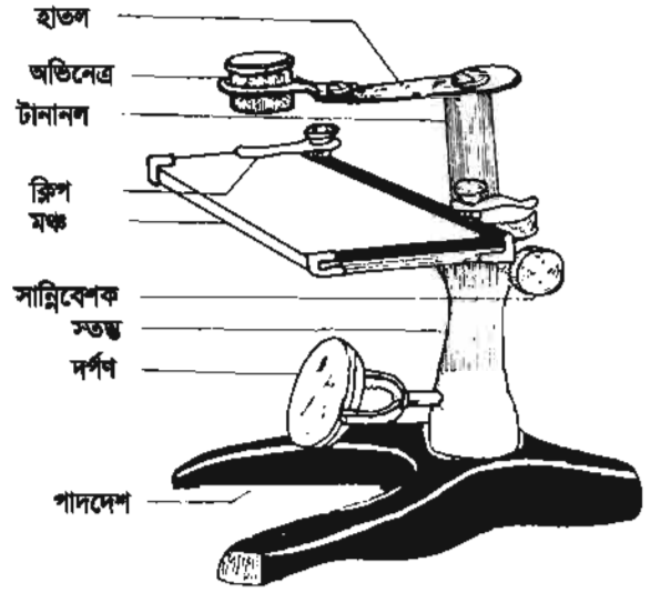
চিত্র-২.২৫: একটি সরল অণুবীক্ষণযন্ত্র।
